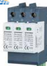
EP-C40 DC 3P 1000V T2 Uc:1000V,In:20kA, Imax:40kA (3 Faz 1000V DC, C Sınıfı, 40 kA)
