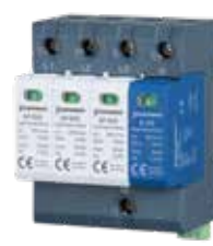
EP-D20/3+1 T2 Uc:275V,In:10kA, Imax:20kA (3 Faz+N, D Sınıfı, 20 kA)
